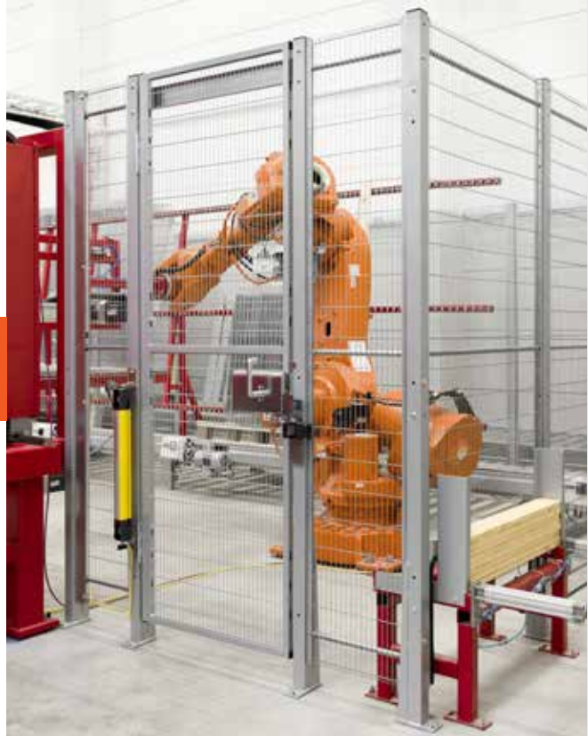
Machine guards Protección de máquinas
