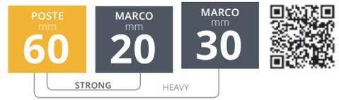
**STRONG** es el sistema de vallado, compuesto por **postes de 60x60 mm** y paneles con marco de **20x20 mm** (o 30x30 mm en la versión **HEAVY**), diseñado para uso en condiciones difíciles.
