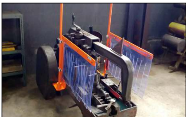
Ejemplo protección con seguridad eléctrica. Enlace web.
