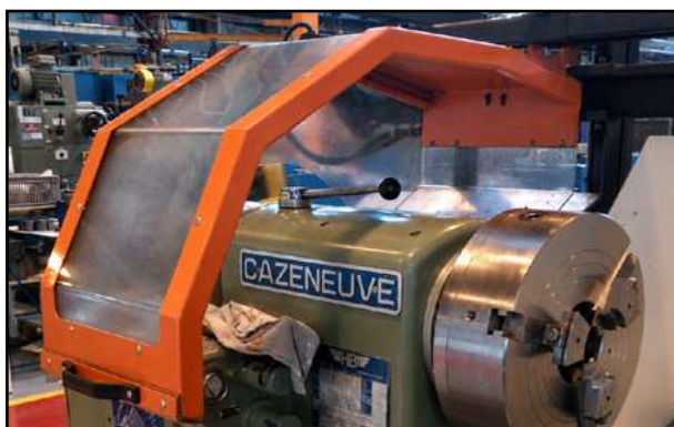
Ejemplo de protección batiente. Enlace a web.
