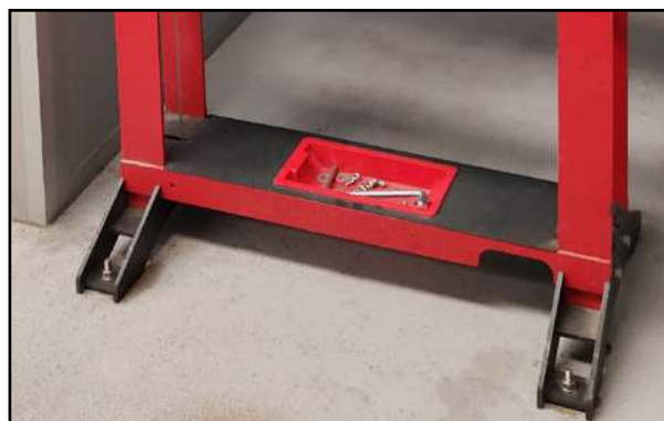
Ejemplo de fijación al suelo.
