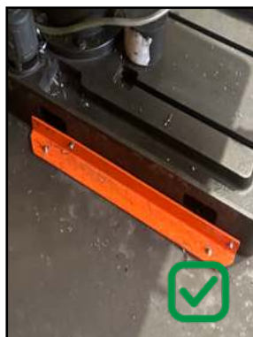
Ejemplo de fijación al suelo.
