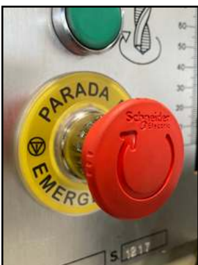
Parada de emergencia adecuada.
