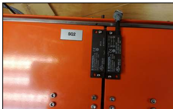
Dispositivo de enclavamiento en resguardo.
