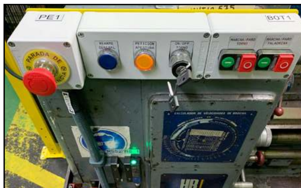
Ejemplo de botoneras acordes con la normativa.
