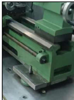
Ejemplos correctos de fijación al suelo y a mesa.
