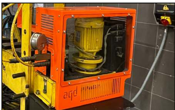
Ejemplo de protecciones a medida.
