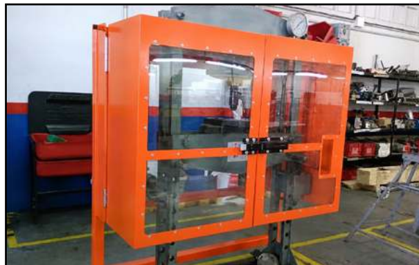
Ejemplo de protección envolvente.
