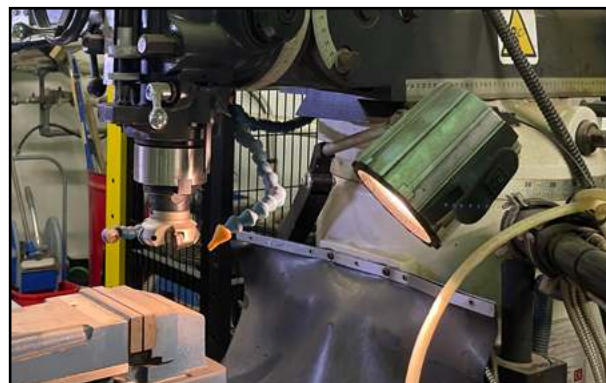
Ejemplos correctos de iluminación fija y orientable.
