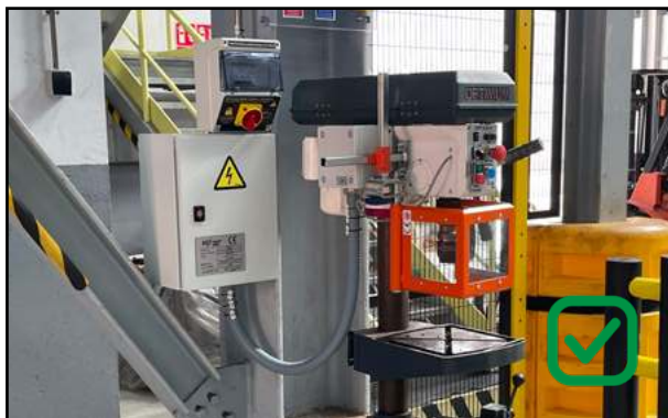
Ejemplos de armario, acometida, botoneras, parada de emergencia e iluminación adecuados.
