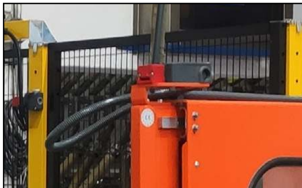
Dispositivo de enclavamiento en resguardo.
