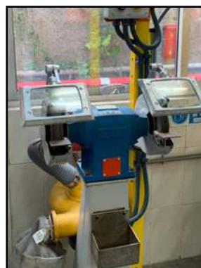
Ejemplo de sistema de recuperación de polvo. Enlace web.
