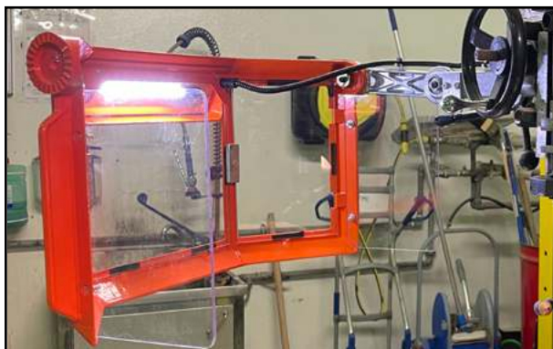
Ejemplos correctos de iluminación fija y orientable.
