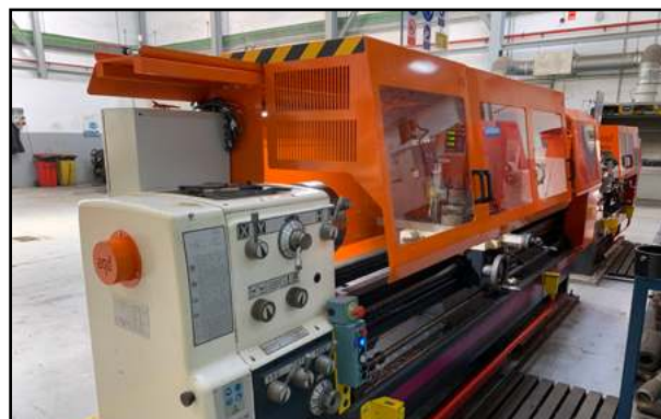
Ejemplo de protección envolvente a medida.
