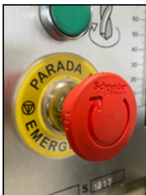
Parada de emergencia adecuada.
