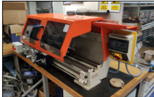
Ejemplo de protección envolvente. Enlace web.
