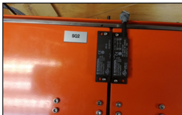
Dispositivo de enclavamiento en resguardo.
