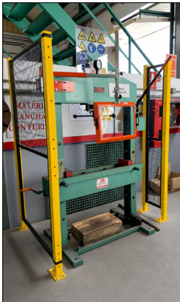
Ejemplo de protección realizada con vallado. Enlace a vallado
