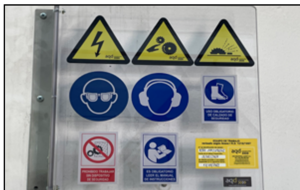
Ejemplo de señalización de peligros y medidas de seguridad. Enlace web a placa de advertencias.
