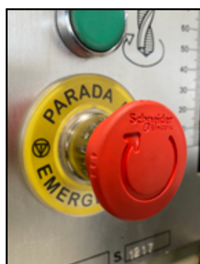
Parada de emergencia acorde a la normativa.
