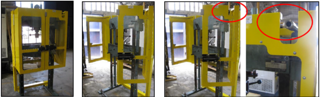
Ejemplo de protección envolvente adecuada.
