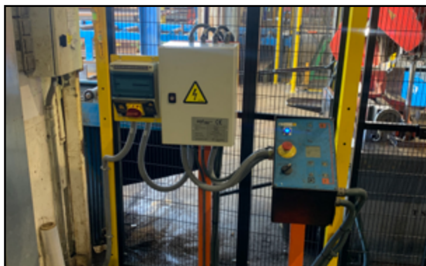
Ejemplos de dispositivos de desconexión de potencia con protección magnetotérmica y diferencial, y neumática (cuando proceda). Enlace web a la protección de alimentación eléctrica
