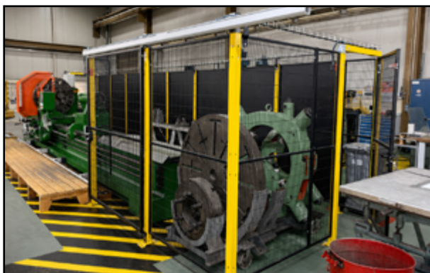
Ejemplo de protecciones a medida y con vallado. Enlace web a vallado de seguridad.
