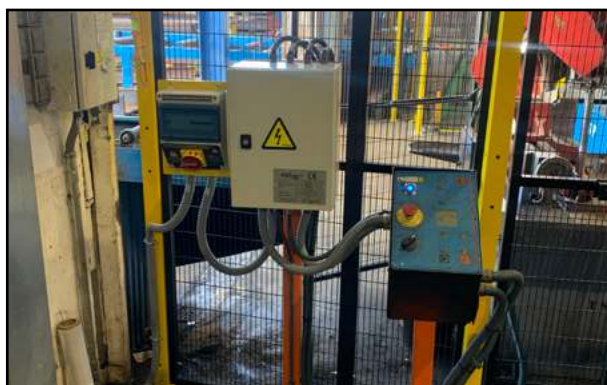
Ejemplos dispositivos de desconexión de energías con sistema de consignación. Enlace web a protección de alimentación eléctrica
