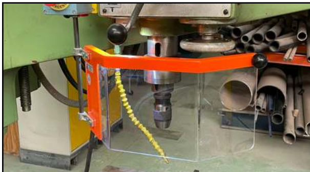
Ejemplo de protección batiente. Enlace web a la protección.
