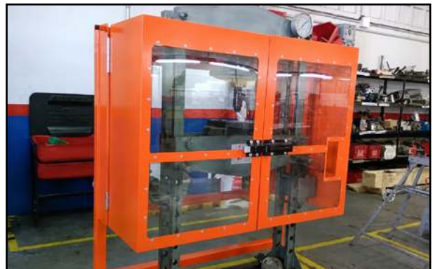
Ejemplo de protección envolvente.
