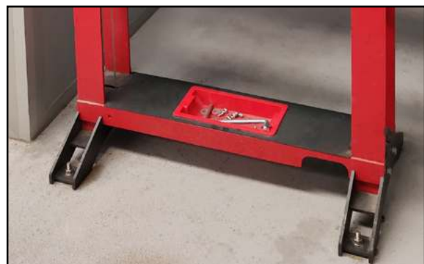
Ejemplo de fijación al suelo.
