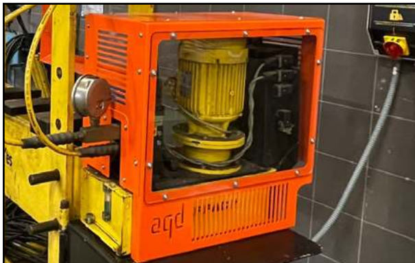
Ejemplo de protecciones a medida.
