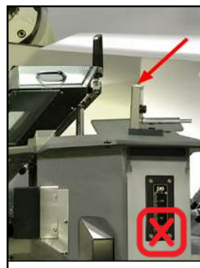
Taladro sin protección en un punto donde hay riesgo de atrapamiento.
