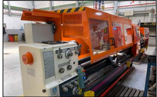
Ejemplo de protección envolvente a medida.
