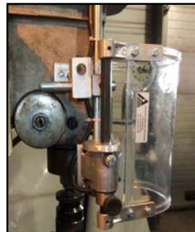
Ejemplo de protección batiente. Enlace web a la protección.
