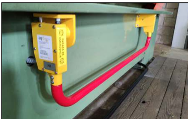
Ejemplo de barra de parada de emergencia. Enlace a la web
