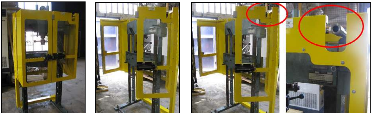
Ejemplo de protección envolvente adecuada.
