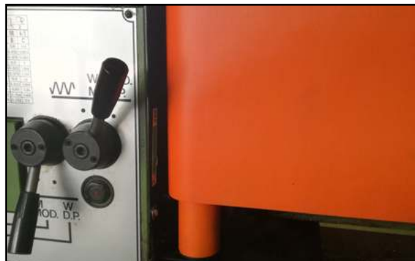
Ejemplo de protección enrollable para husillos.
