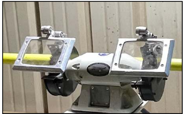
Ejemplo de esmeril con protección frontal batiente y protección envolvente para piedra/cepillo pulidor. Enlace web a la protección frontal.
