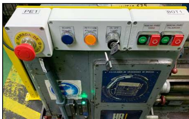
Ejemplo de botonerías acorde con la normativa.
