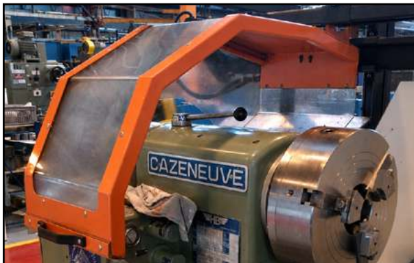
Ejemplo de protección batiente. Enlace a web.
