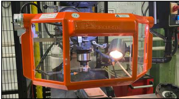
Ejemplo de protección oscilobatiente, con interruptor de seguridad, cristal de seguridad e iluminación led. Enlace web a la protección.
