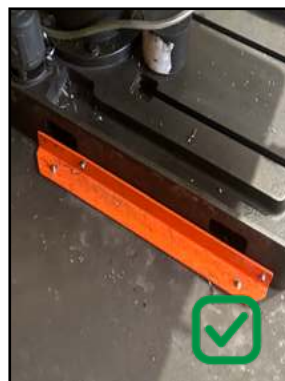
Ejemplo de fijación al suelo.
