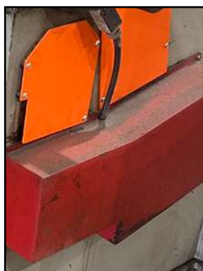
Ejemplo de protecciones para curvadora.
