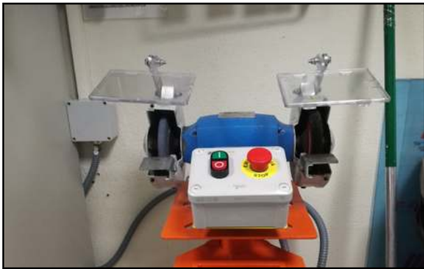
Ejemplo de esmeril con protección frontal batiente y protección envolvente para piedra/cepillo pulidor. Enlace a protector tambor cepillo.
