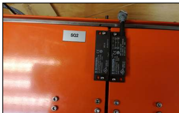
Dispositivo de enclavamiento en resguardo.
