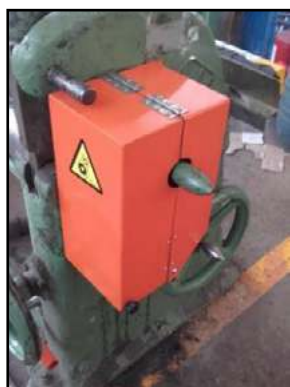
Ejemplo de protecciones para curvadora.
