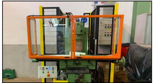
Ejemplo de protección frontal total para fresadoras con interruptor de seguridad, cristal de seguridad e iluminación led, más vallado perimetral. Enlace web al vallado.
