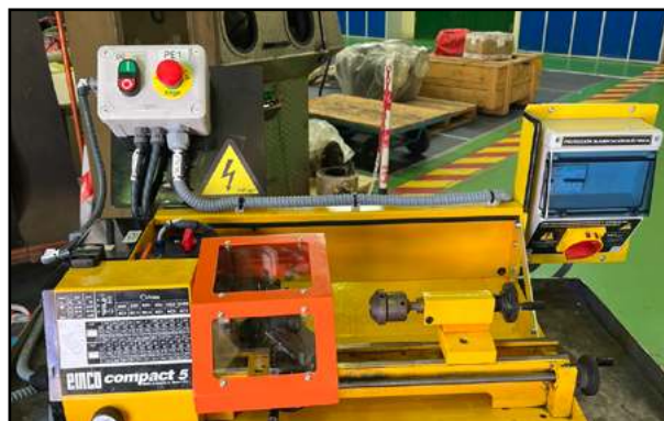
Ejemplos de caja marcha-paro (derecha) y caja de protección eléctrica (izquierda).
