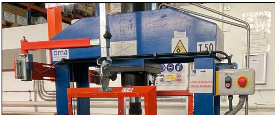
Ejemplos de pulsador, relé y parada de emergencia adecuados.
