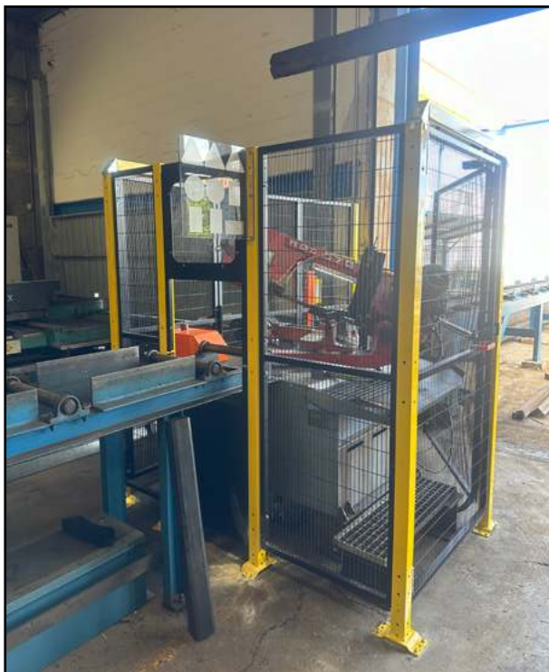
Ejemplo de protección del acceso accidental y proyecciones mediante vallado perimetral. Enlace web al vallado.
