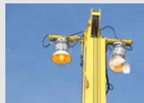
Luz del brazo de una grúa después de una colisión
