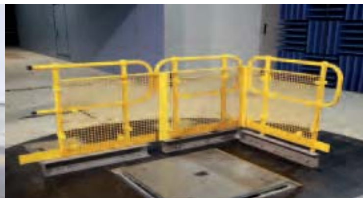
Test en tunel de viento para determinar C_D del Kit Estandar
