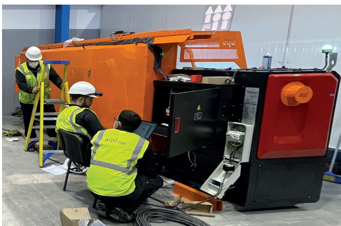
Técnicos adecuando un torno en la central de Lanzarote.
